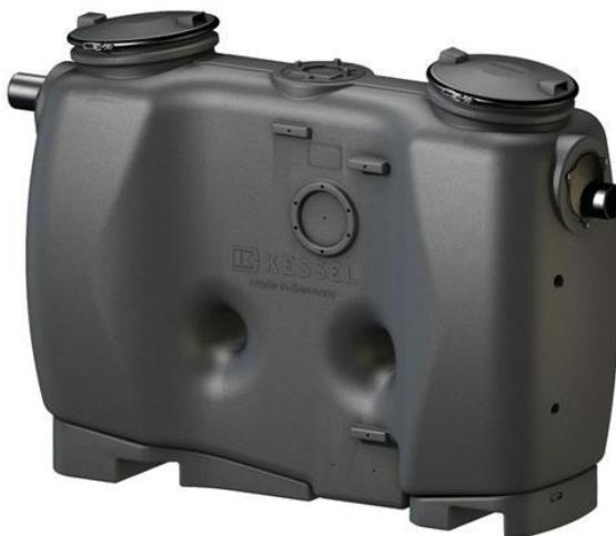
De vetafscheider is een toestel dat geplaatst wordt aan de afvoer van afvalwater van restaurants en kantines. Het is bedoeld om vet op te vangen zodat dit de verdere bebuizing niet verder verstopt. Het maken van deze vetafscheiders is onderworpen aan de EN 1825 norm 1 en 2. De tank is opgesplitst in twee delen: de slib opvanger, en het splitsings compartiment.
