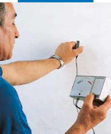
Metten van het vochtgehalte van het gips
