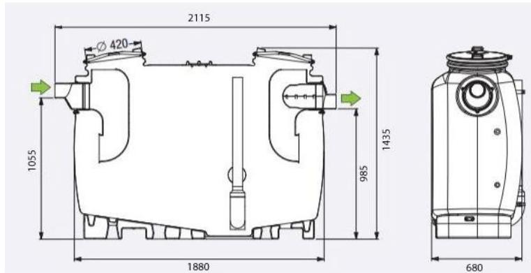
De vetafscheider is een toestel dat geplaatst wordt aan de afvoer van afvalwater van restaurants en kantines. Het is bedoeld om vet op te vangen zodat dit de verdere bebuizing niet verder verstopt. Het maken van deze vetafscheiders is onderworpen aan de EN 1825 norm 1 en 2. De tank is opgesplitst in twee delen: de slib opvanger, en het splitsings compartiment.
